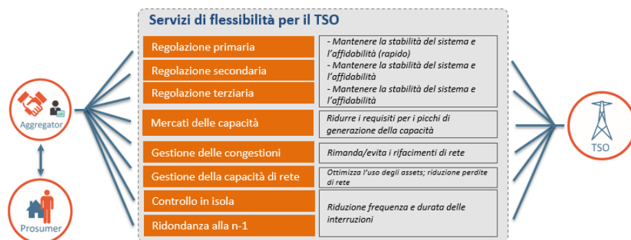
Figura 7 - Servizi di flessibilità per il TSO ed evoluzioni tramite l'aggregatore
